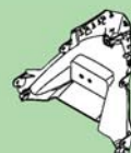
ฝาครอบบังโคลนหลัง COVER, REAR FENDER B74-F1651-00
