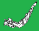
แผ่นรองเท้าข้างขวา BOARD, FOOTREST 2 B6H-F7488-00
